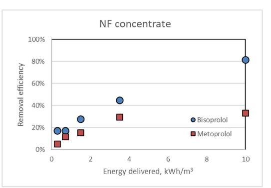
Conductivity 12700  $\mu$ S/cm, TOC 2130 mg/L, COD 5930 mg/L,  $P_{tot}$  380 mg/L,  $N_{tot}$  190 mg/L, metoprolol 78  $\mu$ g/L
