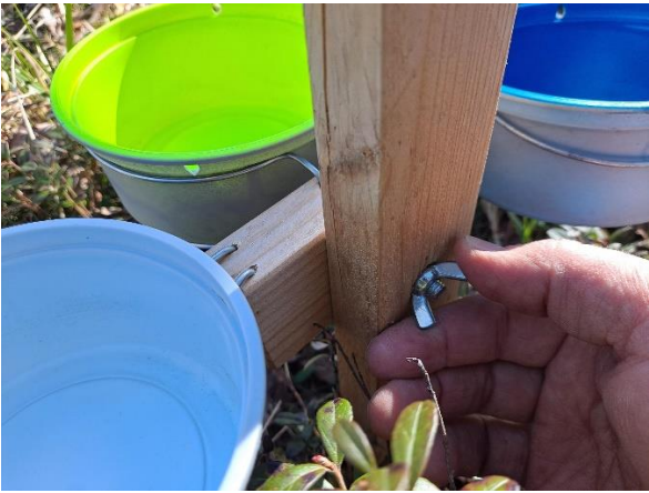
Kuva 5. On tärkeää kiristää pyydyksen takana oleva siipimutteri riittävän kireälle vielä sen jälkeen, kun maljoihin on kaadettu glykoliliuosta. Tarkista samalla, että poikkipuu ja värimaljat ovat vaakatasossa.
