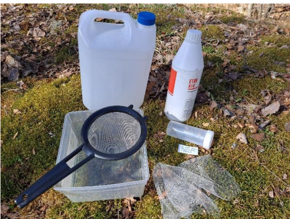
Kuva 6. Värimaljapyydysten koennassa tarvittavat välineet: sihti, harsokangas, keräysastia, näytepurkki, etiketilappu, 30 %:ksi laimennettu glykoliliuos ja 70-80 %:ksi laimennettu etanoliliuos. Mukana on oltava myös tyhjä pullo siltä varalta, että glykoliliuos tarvitsee vaihtaa uuteen.
