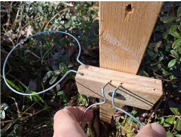
Kuva 3. Upota poikkipuussa oleviin reikäpareihin kolme määrämittaista metallivannetta, jotta niihin voidaan asentaa värimaljat.
