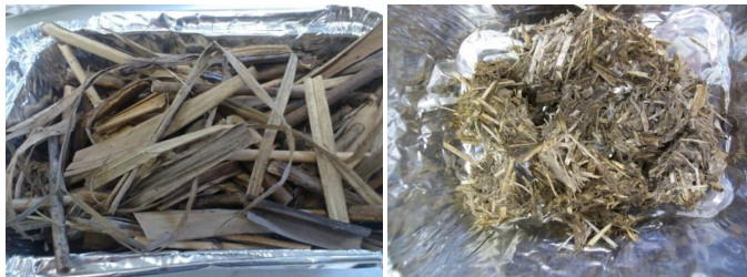
Kuva 1. Järviruoko: Alkuperäinen näyte (vasen) ja murskattu (oikea)
