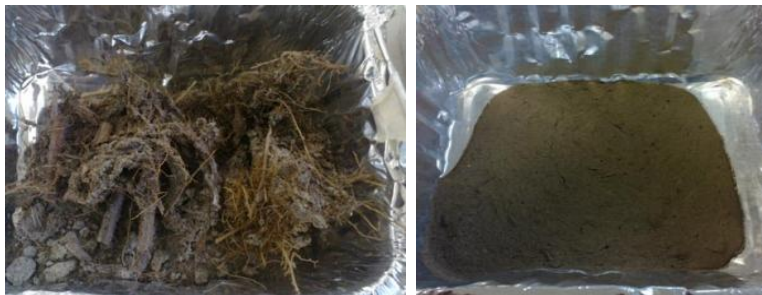
Kuva 3. Sedimentti+ juurakko: Kuivattu alkuperäinen näyte (vasen) ja oikealla murskattu näyte (oikea)
