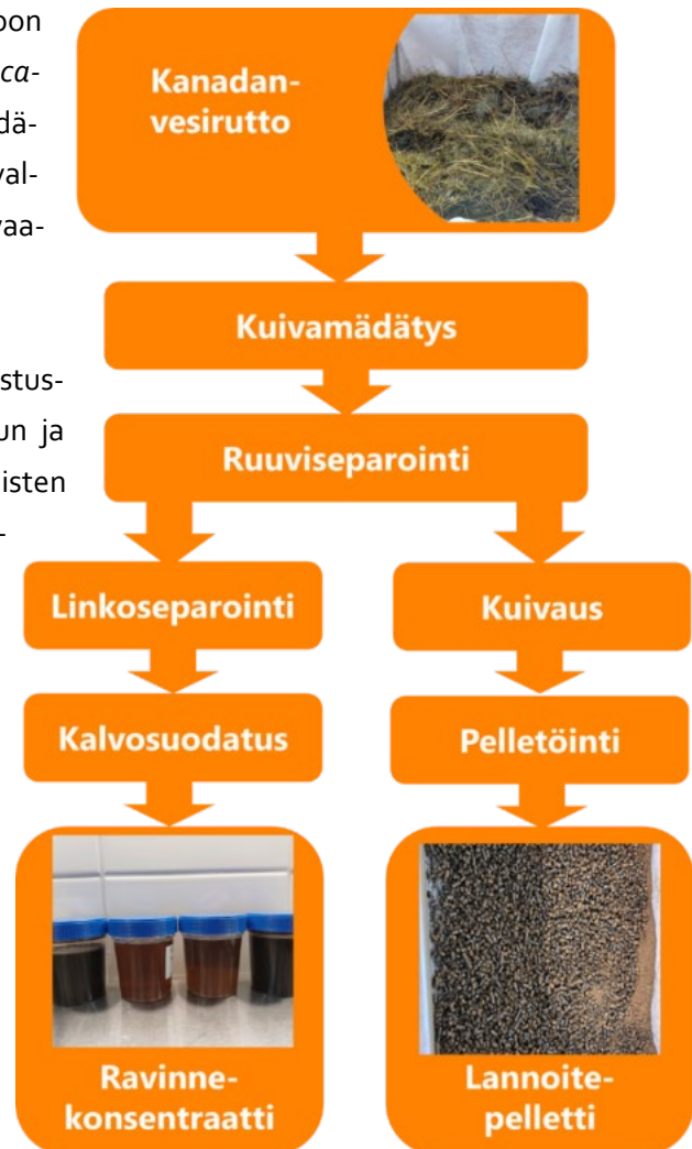
Kanadanvesiruton prosessointiketju neste- ja kuivajakeille Biopajan koelaboratoriossa.
