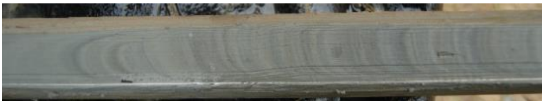
Sulfidisiltti, jossa sulfidi pääasiassa pyriittimuodossa
