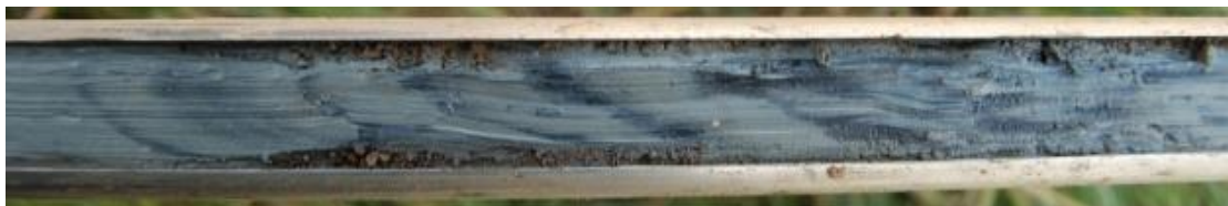
Raidallinen siltti, jossa vaihteleva sulfidipitoisuus
