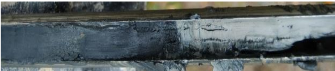
Sulfidisiltti, joka vaihetuu lähes rikittömäksi glasiaalisaveksi
