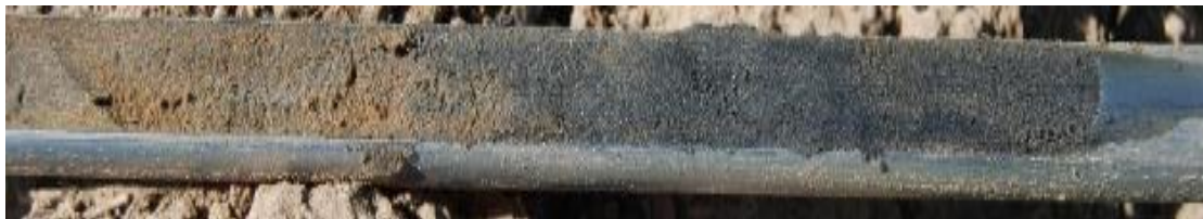
Hapettunut hiekka, joka vaihetuu sulfidipitoiseksi pelkistyneeksi hiekaksi
