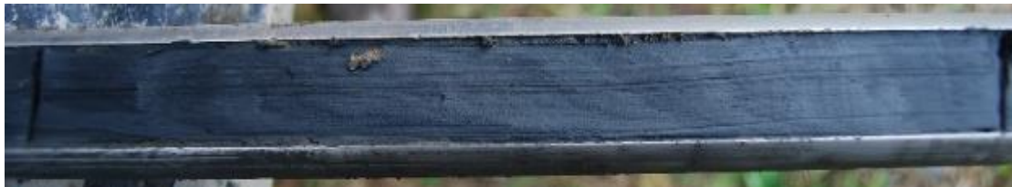
Sulfidisiltti, jossa sulfidi pääasiassa monosulfidimuodossa
