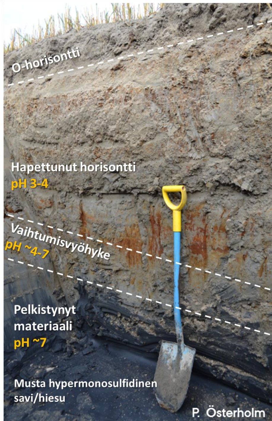
Hapettunut hiekka, joka vaihetuu sulfidipitoiseksi pelkistyneeksi hiekaksi
