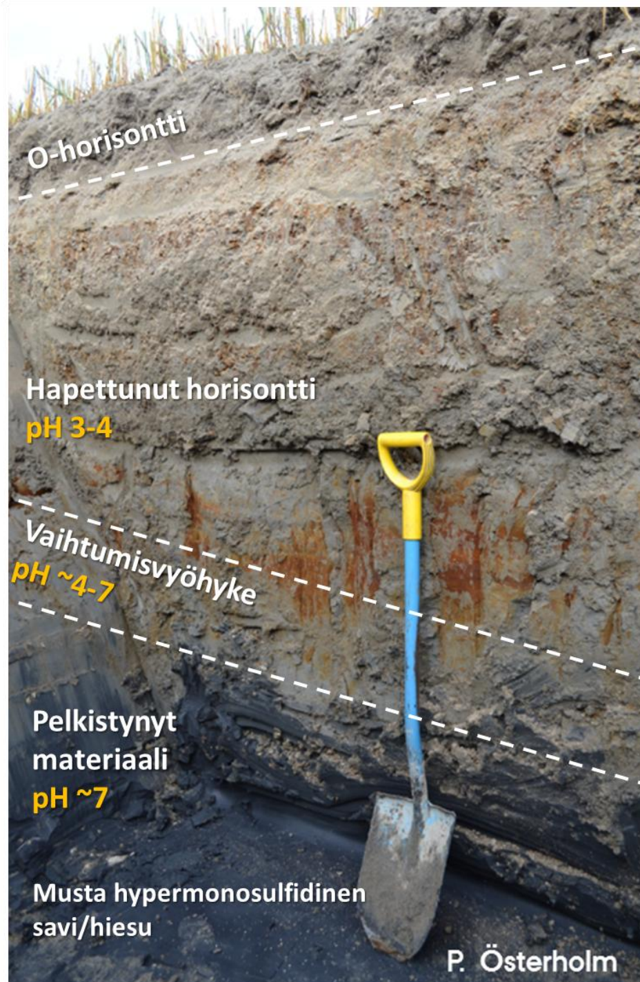
Hapettunut hiekka, joka vaihetuu sulfidipitoiseksi pelkistyneeksi hiekaksi
