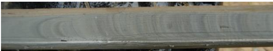
Sulfidisiltti, jossa sulfidi pääasiassa pyriittimuodossa
