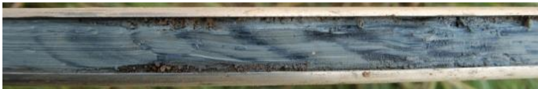
Raidallinen siltti, jossa vaihteleva sulfidipitoisuus
