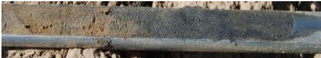
Hapettunut hiekka, joka vaihetuu sulfidipitoiseksi pelkistyneeksi hiekaksi
