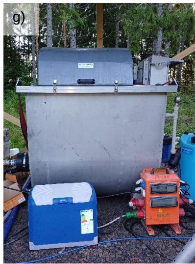
Kuva 6. Linkulasjön-järvellä kesän 2024 aikana toteutetun alusveden suodatuspilotin a) laitteiston yleiskuva, b) syvänteelle asetettu alusveden imuputki, c) järven rantaan asennettu uppopumppu, d) ilmastussammio, e) DynaSand-hiekkasuodatin, f) DynaSandilta lähtevän puhdistetun veden purku järveen laskevaan matalaan, kasvi- ja sammalpeitteiseen ojaan, g) DynaDrum-rumpusuodatin sekä h) rejektivesisammio, josta rejektivedet johdettiin uppopumpulla tiivistetylle siirtolavalle. Kuvat a ja c-h, Laura Härkönen; kuva b, Leena Nurminen.
