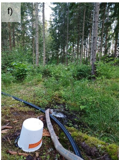
Kuva 6. Linkulasjön-järvellä kesän 2024 aikana toteutetun alusveden suodatuspilotin a) laitteiston yleiskuva, b) syvänteelle asetettu alusveden imuputki, c) järven rantaan asennettu uppopumppu, d) ilmastussammio, e) DynaSand-hiekkasuodatin, f) DynaSandilta lähtevän puhdistetun veden purku järveen laskevaan matalaan, kasvi- ja sammalpeitteiseen ojaan, g) DynaDrum-rumpusuodatin sekä h) rejektivesisammio, josta rejektivedet johdettiin uppopumpulla tiivistetylle siirtolavalle. Kuvat a ja c-h, Laura Härkönen; kuva b, Leena Nurminen.
