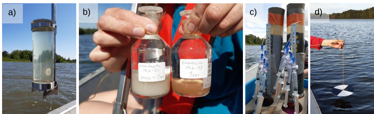
Kuva 4. Valokuvia Linkulasjön-järven näytteenotosta: a) vesinäytteenotossa käytetty Limnos-putkinoudin, b) päänäytteen (oikealla) ja alusveden (vasemmalla) happinäytteet kesäkuussa 2023, c) sedimenttinäytteenotossa käytetyt putkinoutimet ja Rhizon-suodattimet sedimenttien huokosvesinäytteitä varten sekä d) näkösyvyyden mittausta Secchi-levyllä syyskuussa 2024. Kuvat a ja c, Laura Härkönen sekä kuvat b ja d, Kaarina Lukkari.
