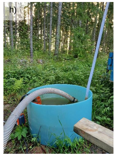
Kuva 6. Linkulasjön-järvellä kesän 2024 aikana toteutetun alusveden suodatuspilotin a) laitteiston yleiskuva, b) syvänteelle asetettu alusveden imuputki, c) järven rantaan asennettu uppopumppu, d) ilmastussammio, e) DynaSand-hiekkasuodatin, f) DynaSandilta lähtevän puhdistetun veden purku järveen laskevaan matalaan, kasvi- ja sammalpeitteiseen ojaan, g) DynaDrum-rumpusuodatin sekä h) rejektivesisammio, josta rejektivedet johdettiin uppopumpulla tiivistetylle siirtolavalle. Kuvat a ja c-h, Laura Härkönen; kuva b, Leena Nurminen.
