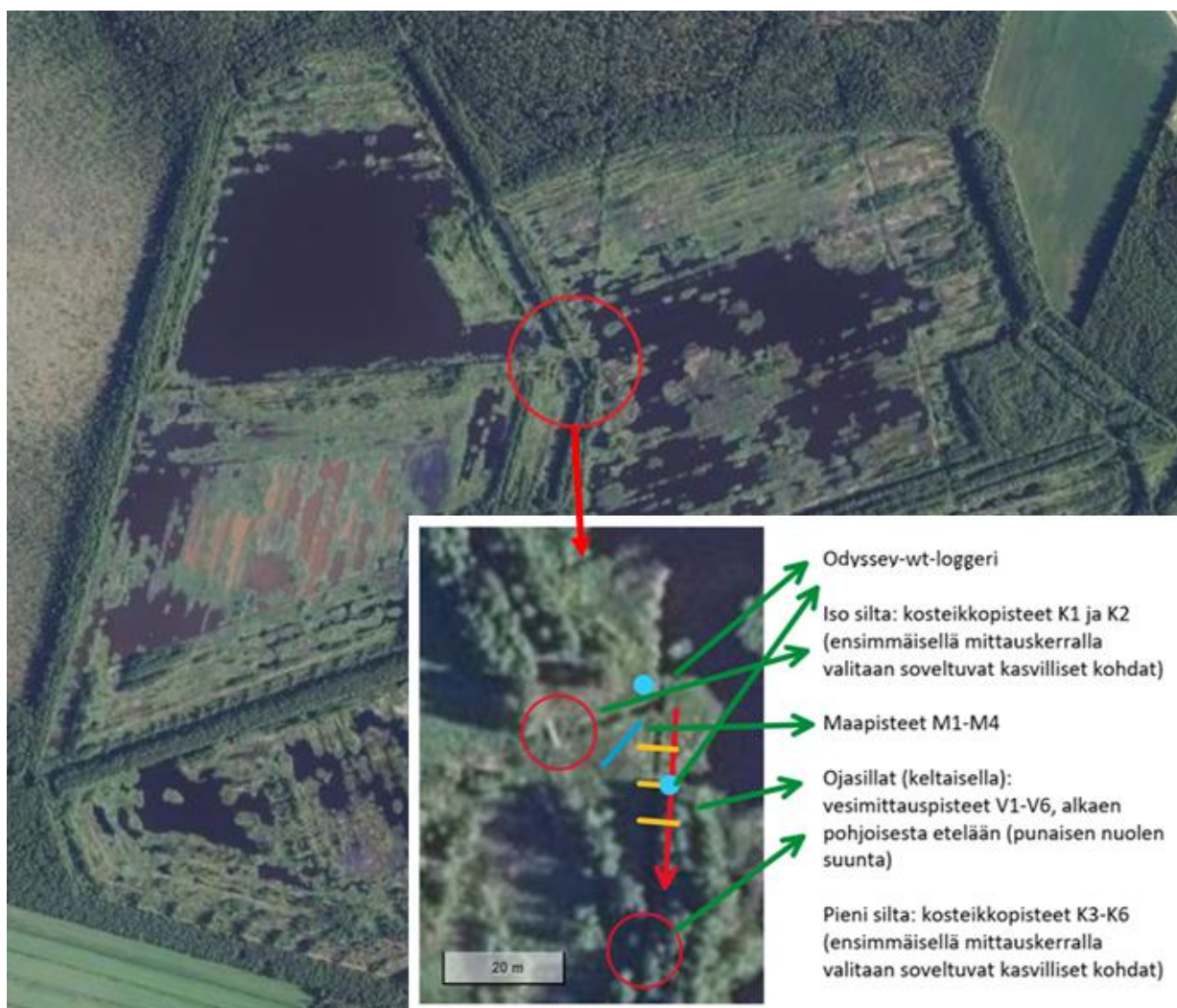
Kuva 3). Maapisteitä eli kausikosteikon mittauspisteitä oli neljä (M1-M4) ja ne sijaitsivat ison sillan kosteikkopisteiden ja avoveden mittauspaikan välimaastossa. Avoveden mittaukset tehtiin ojasta pisteiltä V1-V6. Avoveden mittauspaikan vesi osin puiden varjostamaa ja kosteikko ja kausikosteikon alue olivat hyvin kasvittuneita (
