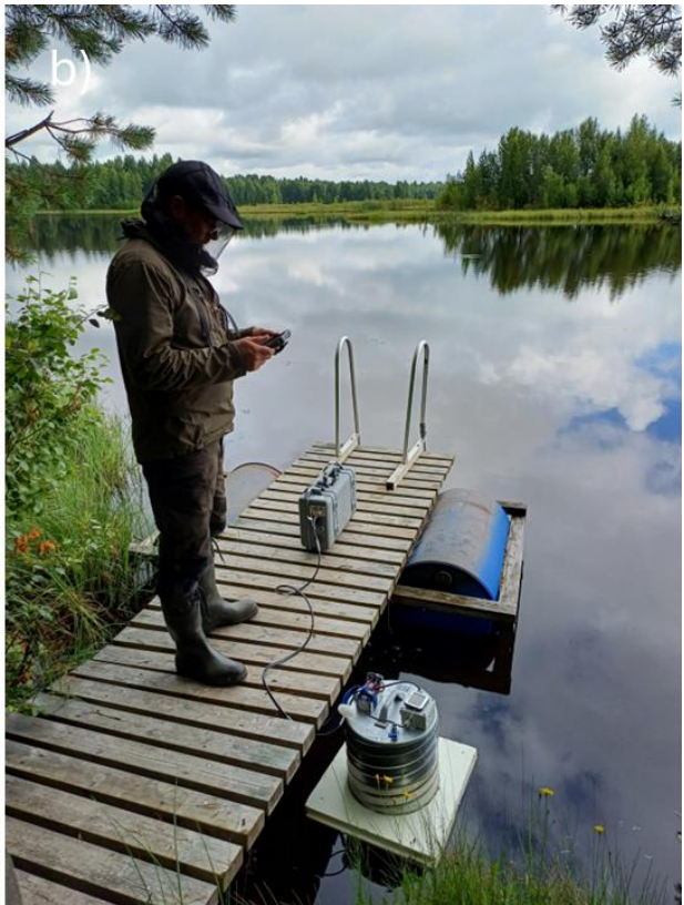
Kuva 7). Paikalle asennettiin kaksi lämpötilaa jatkuvasti mittaavaa HOBO-loggeria, yksi kosteikolle ja yksi veteen, sekä kaksi vedenpinnan korkeutta jatkuvasti mittaavaa Odysseytä (yksi kosteikolle, yksi veteen).
