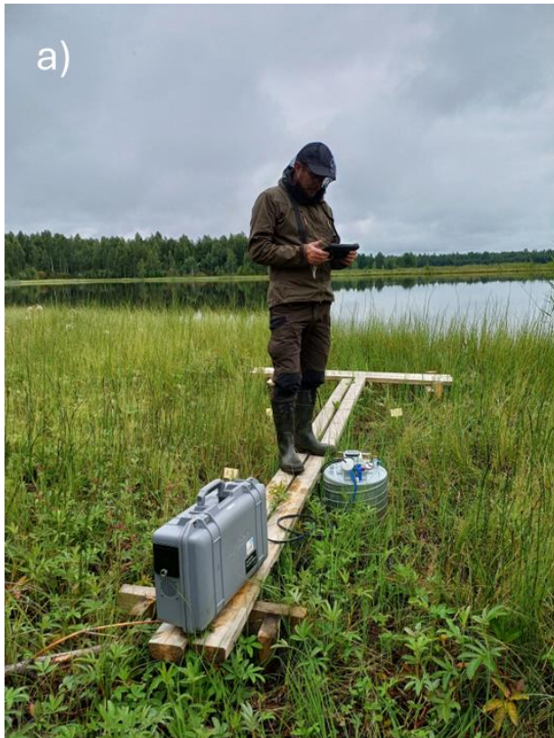
Kuva 7). Paikalle asennettiin kaksi lämpötilaa jatkuvasti mittaavaa HOBO-loggeria, yksi kosteikolle ja yksi veteen, sekä kaksi vedenpinnan korkeutta jatkuvasti mittaavaa Odysseytä (yksi kosteikolle, yksi veteen).
