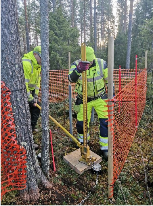
Kuva 4: Tankojen nostoa korroosiopilottikoe kentältä. Kuva: Mirkka Visuri
