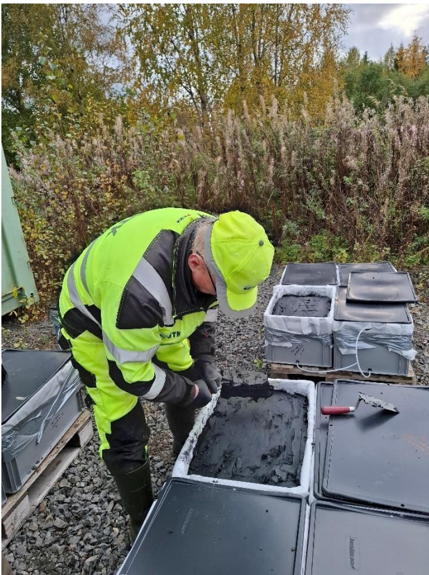
Kuva 3. Neutralointimateriaalit sekoitettiin karkearakeiseen sulfaattimaa-ainekseen betonimyllyn avulla ja hienorakeiseen sulfaattimaa-ainekseen sähkökäyttöisellä sekoittimella.
