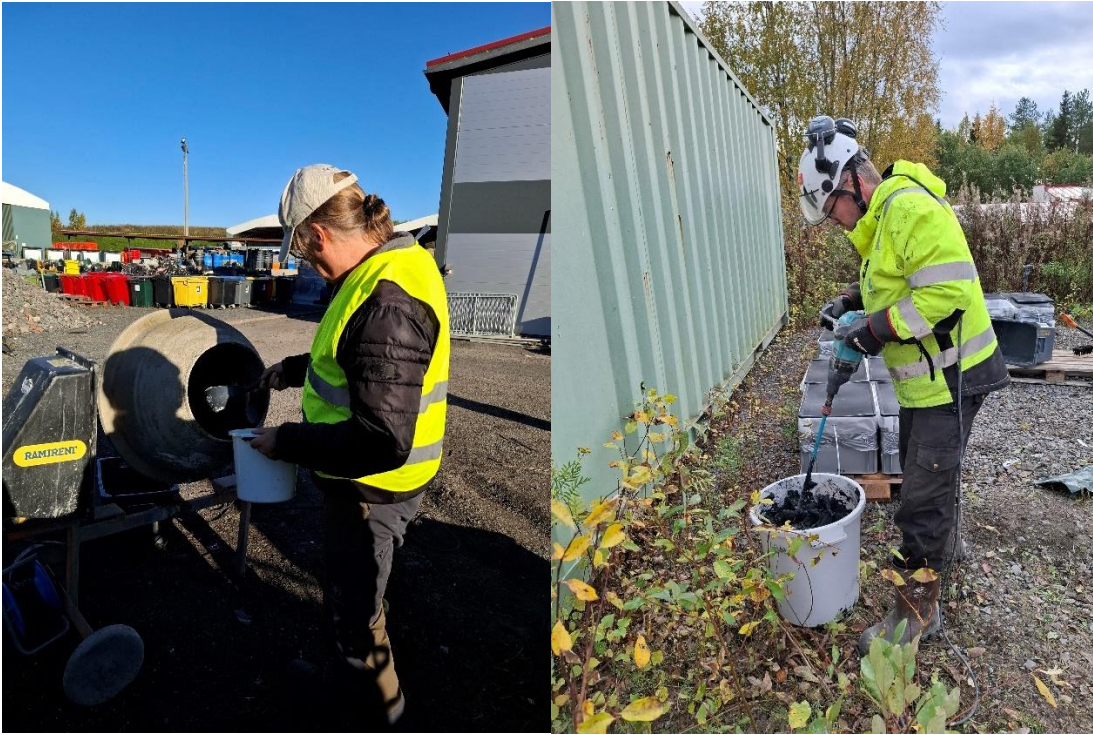
Kuva 3. Neutralointimateriaalit sekoitettiin karkearakeiseen sulfaattimaa-ainekseen betonimyllyn avulla ja hienorakeiseen sulfaattimaa-ainekseen sähkökäyttöisellä sekoittimella.
