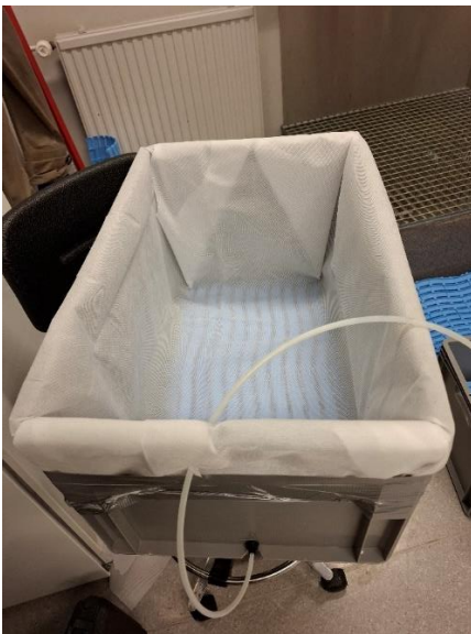
Kuva1. Neutralointipilottikokeita varten rakennettu laatikko, jossa suodosvesien keräysmahdollisuus.
